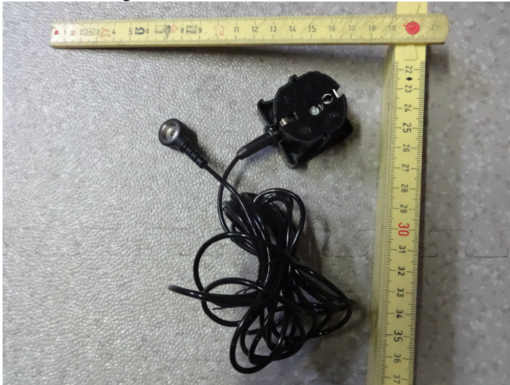
Bild 3 - Earthing-Kabel mit Schutzkontaktstecker ohne stromführende Stifte
